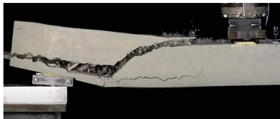
Иллюстрация 2. Картина разрушения балки по наклонному сечению при испытаниях опытного образца. Скриншот из видео Engineering education company «Think Up». Источник: https://www.youtube.com/playlist?list=PLXdvc710lmy_INX5vY1e6YQKe66MZ022
