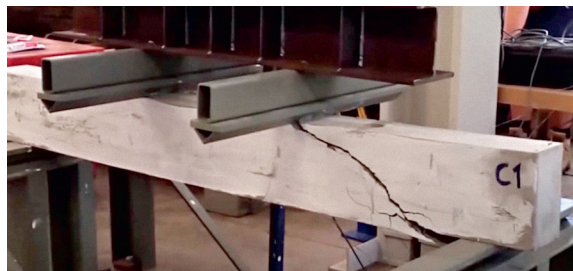
Иллюстрация 3. Картина разрушения балки по наклонному сечению при испытаниях опытного образца. Скриншот из видео Engineering education company «Think Up». Источник: https://www.youtube.com/playlist?list=PLXdvc710lmy_INX5vY1e6YQKe66MZ022
