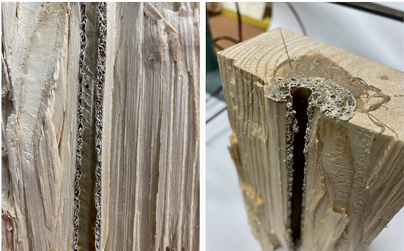
Иллюстрация 10. Выполнение наблюдений образца на полиуретановом клее. Авторы: С. А. Еренчинов, С. А. Минигалеева
