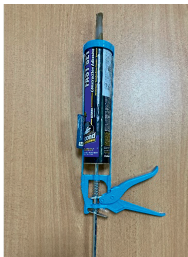
Иллюстрация 2. Заполнение отверстий полиуретановым клеем. Фото: С. А. Еренчинов, С. А. Минигалеева
