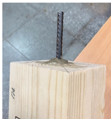
Иллюстрация 3. Погружение арматурного стержня. Фото: С. А. Еренчинов, С. А. Минигалеева
