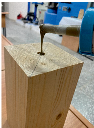
Иллюстрация 2. Заполнение отверстий полиуретановым клеем. Фото: С. А. Еренчинов, С. А. Минигалеева
