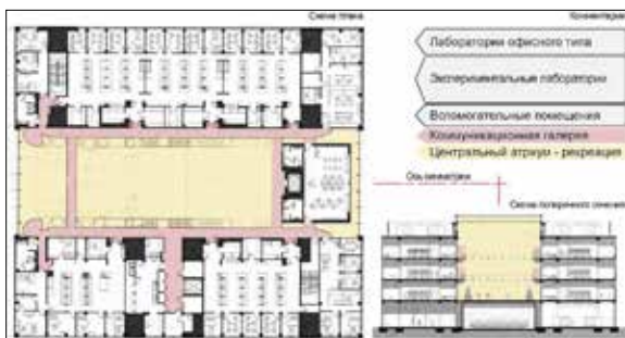
Иллюстрация 6. Планировочный прием организации лабораторных зданий с центральным атриумом [3]
