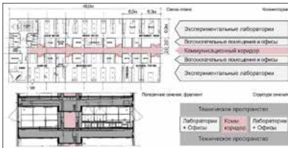
Иллюстрация 3. Планировочный прием организации лабораторных зданий с одним внутренним коридором [3]
