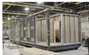
Иллюстрация 8. Блоки-модули для здания Stack building на заводе Deluxe Building Systems. Пенсильвания, США. Источник: https://gluckplus.com/project/the-stack
