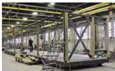
Иллюстрация 8. Блоки-модули для здания Stack building на заводе Deluxe Building Systems. Пенсильвания, США. Источник: https://gluckplus.com/project/the-stack
