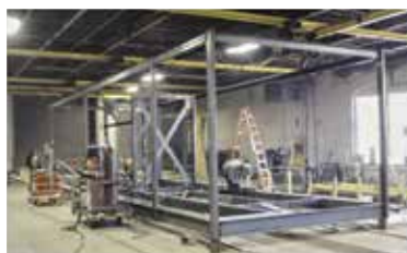
Иллюстрация 6. Изготовление модулей для Carmel Place. Завод Capsys. Бруклин, Нью-Йорк, США. Источник: https://narchitects.com/work/carmel-place/
