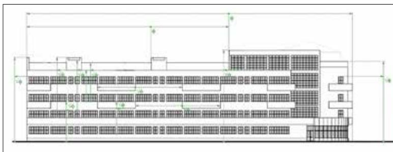
Иллюстрация 11. Использование регулирующей пропорции  $\sqrt{\phi}$  на примере южного фасада Дома культуры. Арх. М. В. Рейшер. Автор А. В. Долгов
