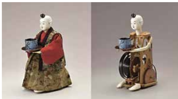
Иллюстрация 9. Традиционная японская механическая кукла «каракури-нинге» в виде мальчика, доставляющего чай. Источник: https://prtimes.jp/main/html/rd/p/000000121.000047031.html
