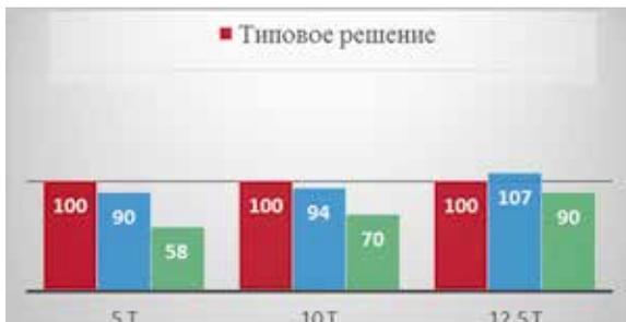
Иллюстрация 5. Гистограмма распределения процентного соотношения веса балок пролетом 12 м для кранов грузоподъемностью от 5 до 12,5 т. Авторы: С. В. Кудрявцев, З. В. Беляева, Ч. Вэйхан, Ч. Пэньюэ
