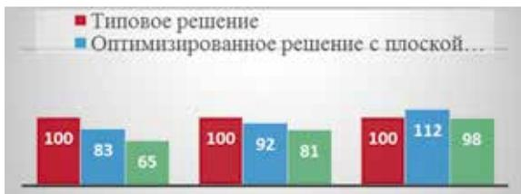
Иллюстрация 4. Гистограмма распределения процентного соотношения веса балок пролетом 6 м для кранов грузоподъемностью от 5 до 12,5 т. Авторы: С. В. Кудрявцев, З. В. Беляева, Ч. Вэйхан, Ч. Пэньюэ
