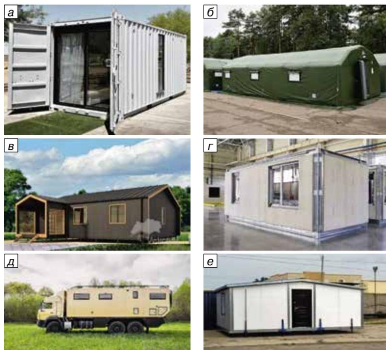
Иллюстрация 1. Виды мобильных жилищ: а — контейнерный<sup>1</sup>; б — пневмокаркасный<sup>2</sup>; в — каркасно-щитовой<sup>3</sup>; г — модульный<sup>4</sup>; д — автодом<sup>5</sup>; е — дом-трансформер<sup>6</sup>
