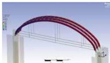
Иллюстрация 3. Несъемная опалубка (пространственная модель конструкции, программный комплекс ANSYS).
