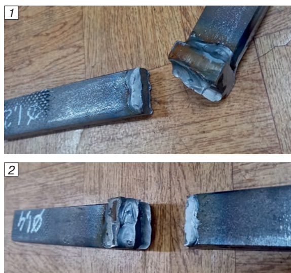
Иллюстрация 5. Разрушение тавровых сварных соединений: 1 — заваренного проволокой диаметром 1,2 мм; 2 — заваренного проволокой диаметром 1,4 мм. Авторы фото: Н. В. Малых, З. В. Беляева
