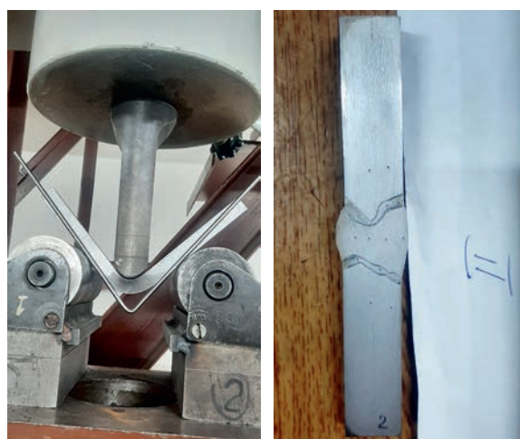
Иллюстрация 4. Испытание образцов на загиб и определение твердости основного металла, зоны термического влияния и металла шва. Авторы фото: Н. В. Малых, З. В. Беляева
