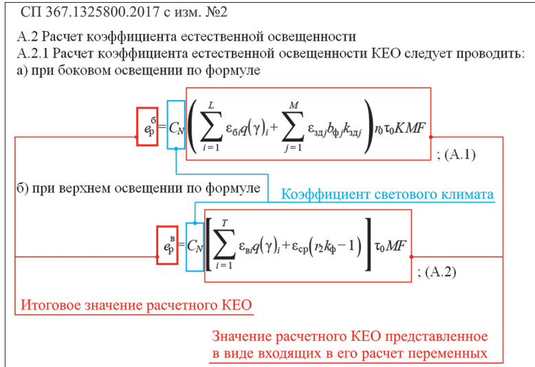
Иллюстрация 2. Использование коэффициента светового климата при корректировке полученного значения КЕО при работе с графиками на примере формул А.1 и А.2 СП 367 для проверочного расчета КЕО. Автор схемы А. В. Колмаков
