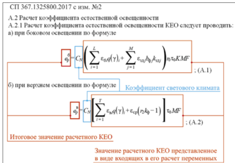
Иллюстрация 2. Использование коэффициента светового климата при корректировке полученного значения КЕО при работе с графиками на примере формул А.1 и А.2 СП 367 для проверочного расчета КЕО. Автор схемы А. В. Колмаков
