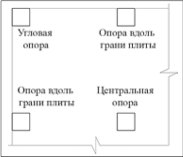
Иллюстрация 6. Расположение моделируемых узлов на плане плиты перекрытия. Автор А. М. Бударин
